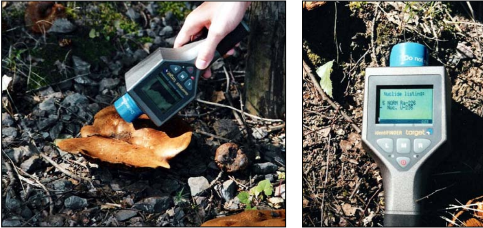
Abb.5: Einsatz eines identiFINDER® ultra zur Messung der Umweltradioaktivität in der Sächsischen Schweiz:
